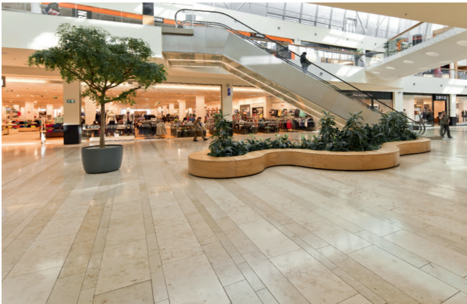
Beim Refurbishment des Wiener Donauzentrums wurde der Kunststeinboden durch Jura Kalkstein ersetzt.
