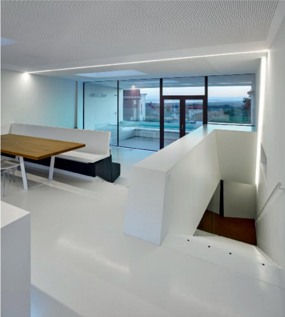
des Hauses geziegelt. Die Oberflächen sind innen und außen homogen weiß. Die Fassade besteht aus einem Wärmedämmverbundsystem mit einer zusätzlichen Glattschicht, die Fußböden aus einer weißen Polyurethanbeschichtung auf Zementestrich, die Möbel aus weißen Mineralstoffplatten. Der Pool ist mit einer weißen PVC-Folie ausgekleidet. Die Dynamik der Form wird mit den über die Flächen durchlaufenden LED-Lichtbändern der Innenbeleuchtung weitergeführt. •
